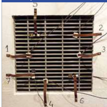
Ventilodice V avant essai de résistance au feu (face non exposée)
